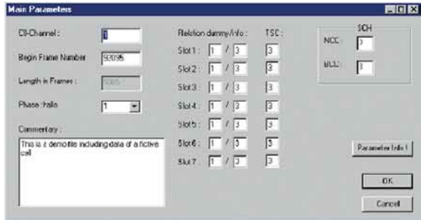
Einstellung der Basisparameter BCCH, Timeslots und Training Sequence Code (TSC)
